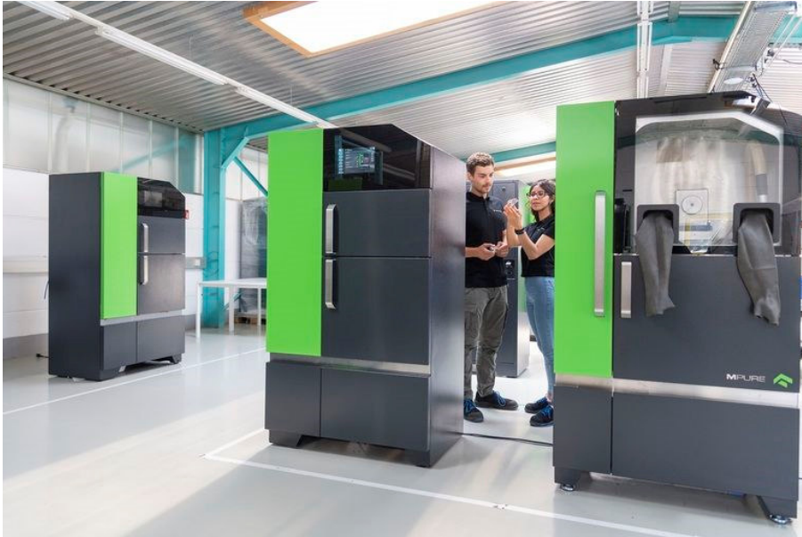
50 Bild 002: Die Metall-3D-Drucklösung Boldseries besteht aus dem 3D-Drucker MPRINT+, der Auspackstation inklusive Siebeinheit MPURE und der Datenvorbereitungssoftware MPREP. Bild: One Click Metal GmbH
